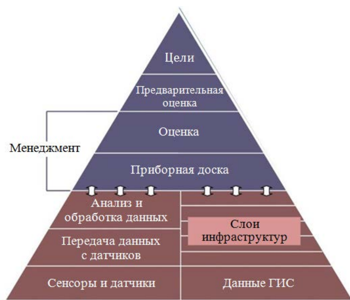
Рисунок 1.1.2 – Схема методологии ЖИБУР аналог систем диагностики и мониторинга надежности технических систем (оборудования нефтеперекачивающих и газокomppressorных станций, высотных зданий, мостов и т.п.)
