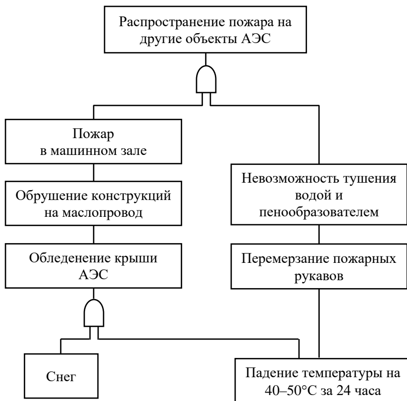
Рисунок 2.16 – Дерево отказов аварии на БАЭС
