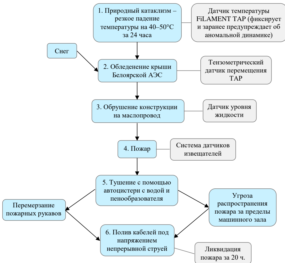
Рисунок 2.17 – Применение датчиков для предотвращения аварии на БАЭС
