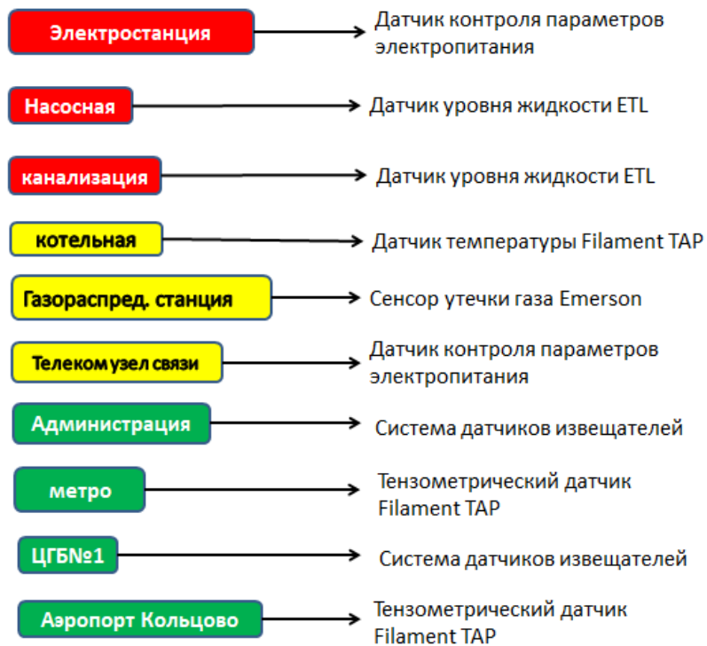
Рисунок 2.21 – Датчики и сенсоры для мониторинга ситуации на ключевом объекте
