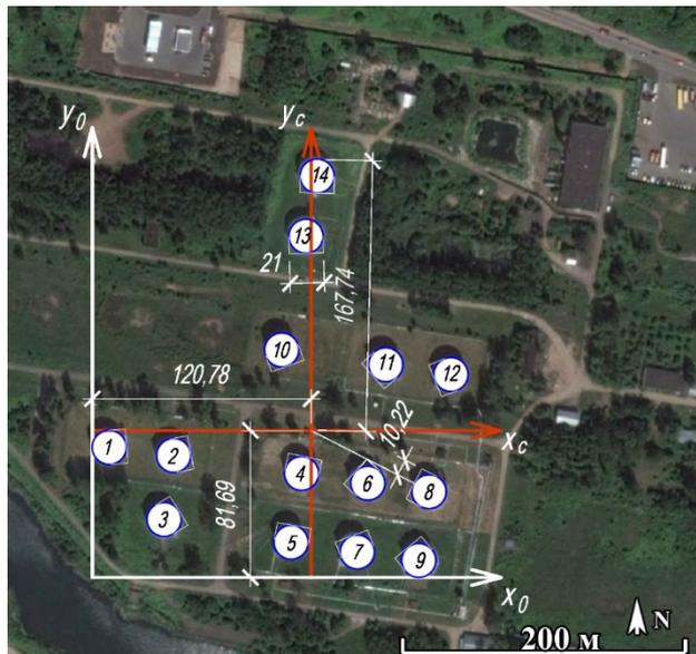
Рисунок 3.20 – Определение параметров резервуарного парка
