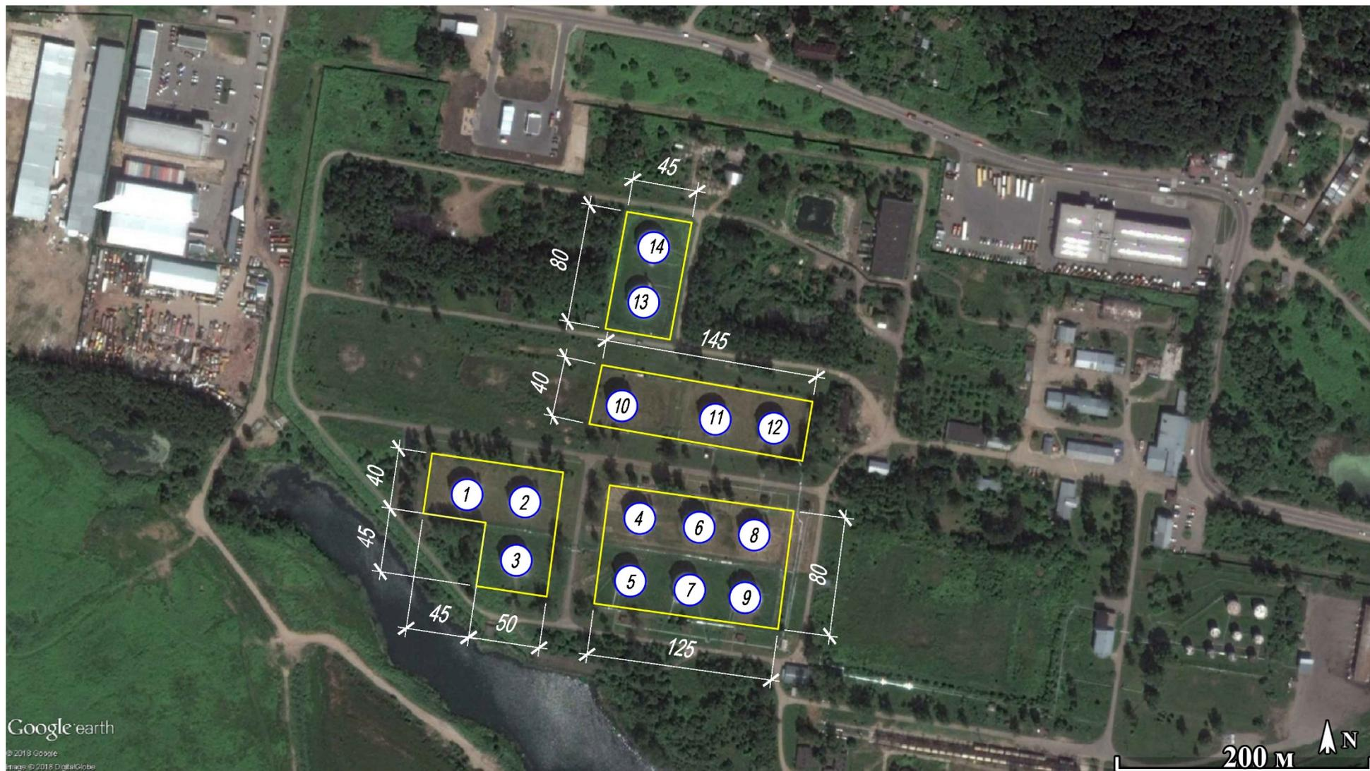
Рисунок 3.19 – Ситуационный план резервуарного парка
