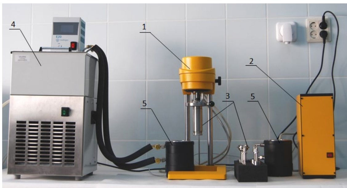
Рисунок 6.2 – Ротационный вискозиметр Rheotest RN 4.1: 1 – вискозиметр; 2 – блок управления; 3 – измерительные системы; 4 – криостат; 5 – термостатирующие сосуды
