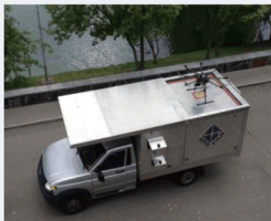
Привязная высотная беспилотная платформа «Альбатрос» (ФПИ)
